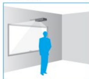
C. Projektor z szerokokątną optyką zainstalowany nad tablicą
